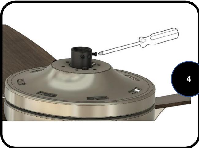
4. Afloje pero no retire los dos tornillos de ajuste en el yugo. Los tornillos de ajuste deben aflojarse lo suficiente como para insertar completamente la varilla descendente.
