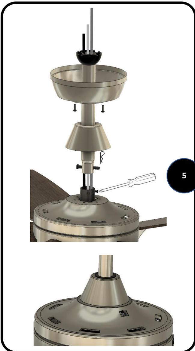
5. Alimenta todos los cables que provienen del ventilador a través de la barra descendente y la bola descendente. Inserte la varilla descendente en el yugo y vuelva a instalar el pasador de la barra descendente y el clip de la varilla descendente. Luego vuelva a apretar los dos tornillos fijos.
