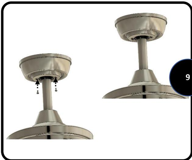
9. Ubique los (2) tornillos en la parte inferior del soporte colgante y afloje los tornillos. Coloque la parte redondeada del orificio ranurado en el dosel sobre los tornillos aflojados en el soporte colgante y empuje hacia arriba. Asegúrese de que todos los cables estén metidos en el dosel y no se pellizquen, incluido el cable negro de la antena. Gire el dosel para bloquearlo. Apriete los tornillos de forma segura.
