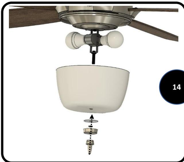
**14.** Atornillar (2) bombillas LED proporcionadas en los zócalos del kit de luz
