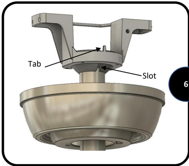
6. Levante la varilla descendente en el soporte de montaje. Gire la varilla descendente hasta que la pestaña del soporte de montaje quede asentada en la ranura de la bola de la varilla descendente.
