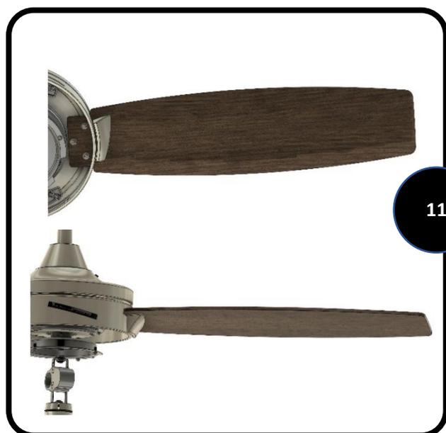
11. Alinee los (2) agujeros en la parte superior del medallón de la hoja con los (2) agujeros en la hoja. Usando (2) tornillos y arandelas de medallón de cuchilla, conecte el medallón de cuchilla en la parte inferior de la cuchilla insertando el medallón de cuchilla en los dos orificios de la cuchilla y atornillando desde la parte superior.
